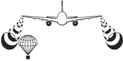
图5 空投伞边缘接触尾涡涡核半径处的位置示意图
